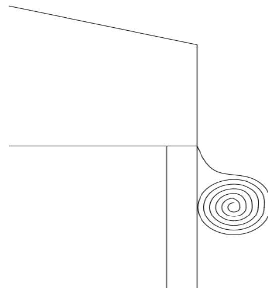
Špatným rolováním plachty se postupně snižuje kvalita a čirost průhledného PVC z důvodu zatékání vody do návinu. Pokud do srolované fólie zaprší a nedojde k urychlenému roztažení, dochází k tzv. „zmléčnění“ okna (efekt mléčného skla), toto je naprostě běžná reakce. Mléčnost časem zmizí. Pokud ne, byla v mokrém stavu srolována dlouhodobě, na což se záruka nevztahuje.
