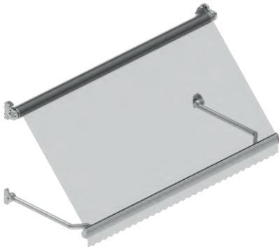
Konstrukci markýzy tvoří válec pro navýjení potahu, výklopná ramena s pružinami, výpadový profil a ovládací mechanismus. Ramena je možné vyklopit do 170°. Markýzu je možné monitovat čelně na fasádu nebo do ostění.
