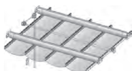
Kotvení zeď - podlaha, ovládání lanovým převodem
