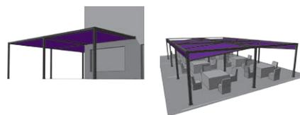
Cubola je jedinečná terasová markýza pro náročné zákazníky. Její краса a specifikum spočívá ve dvojitým sklápěním mechanismu. Jeden ovládá stahování a roztahování potahu, druhý pak naklápění celé markýzy. Cubola tak chrání i před nízkým sluncem a je navíc architektonickým prvkem na terase.
